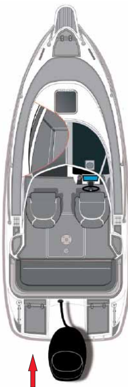
Bild 8. Placeringar för arbetsdäck och räddningsstegen samt räddningsflottens plats.
